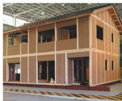
(国研)防災科学技術研究所(つくば市)にて連続5回 巨大地震波 加振後の実物大住宅モデル
